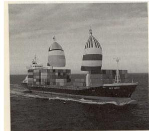
Bild 9.5. Zwei spinnackerförmige Segel von je 480 m² spären auf dem auf dem Containerschiff "Bold Eagle" 10 % Kraftstoff ein. (Quelle: Bremer Vulkan AG)
